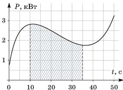
По экспериментальной зависимости мощности нагревателя от времени  $P(t)$  необходимо найти количество теплоты  $Q$ , выделившееся за время
