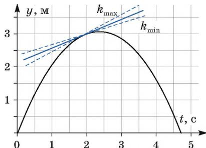
Погрешность  $k$  определяется угловыми коэффициентами «пунктирных» касательных.
