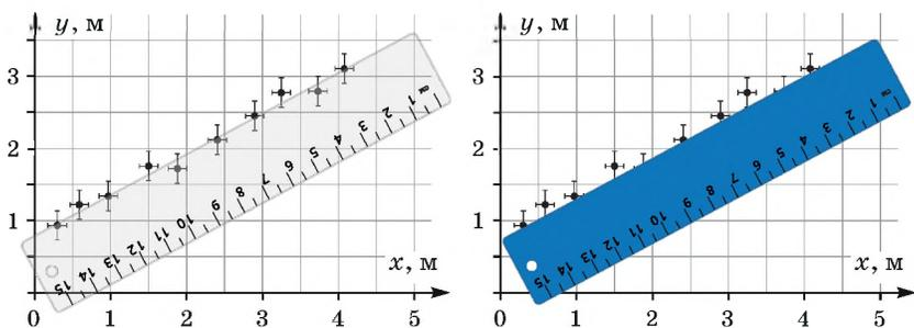
Построив таким образом «наилучшую» прямую для зависимости  $y = kx + b$ , можно найти ее параметры: угловой коэффициент  $k$  и вертикальное смещение  $b$ . Таким же способом можно оценить ошибку определения  $k$  и  $b$ . Смещая линейку вертикально в пределах крестов погрешностей, оценим погрешность  $\Delta b$ , и, изменяя наклон линейки относительно условного «центра масс» экспериментального графика, получим оценку для погрешности углового коэффициента  $\Delta k$ .
